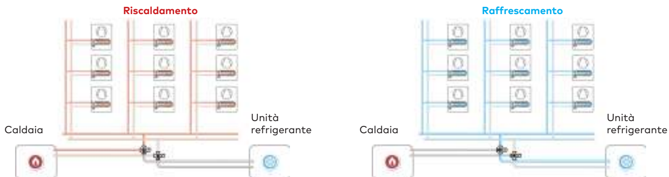
Fig. 1. Commutazione centralizzata dell'intero impianto tra riscaldamento e raffrescamento
