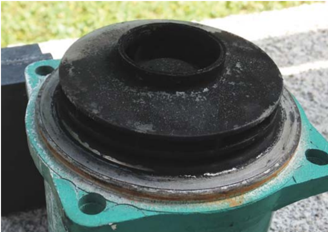
Conséquences et dommages dus à un circuit CVC mal purgé.
