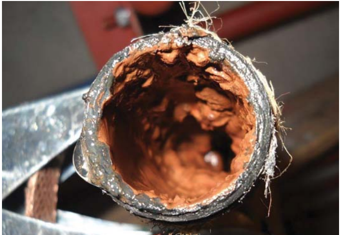
Conséquences et dommages dus à un circuit CVC mal purgé.
