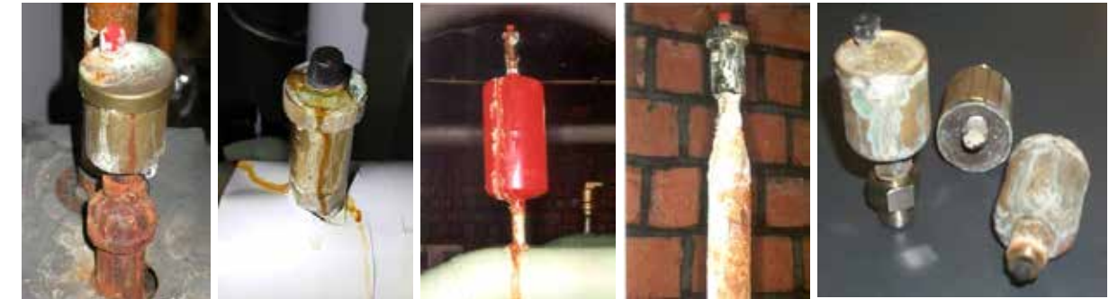
Esempio di valvole di sfogo di scarsa qualità, che iniziano presto a perdere a causa della loro costruzione difettosa
