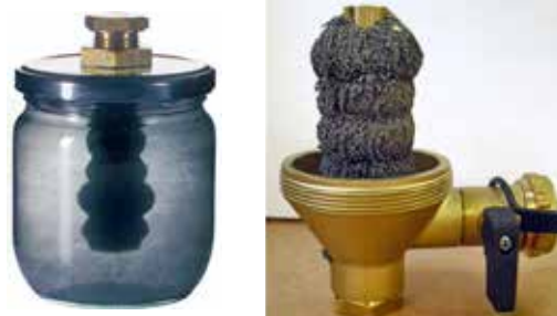
Zeparos stavmagnet kan hålla 143 g järnkulor
